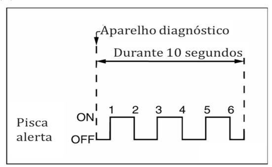
**Nota**: Após ter completado a sequência de acionamento do botão do pisca alerta, as travas irão travar e destravar rapidamente em confirmação de habilitação do modo de aceitação.
